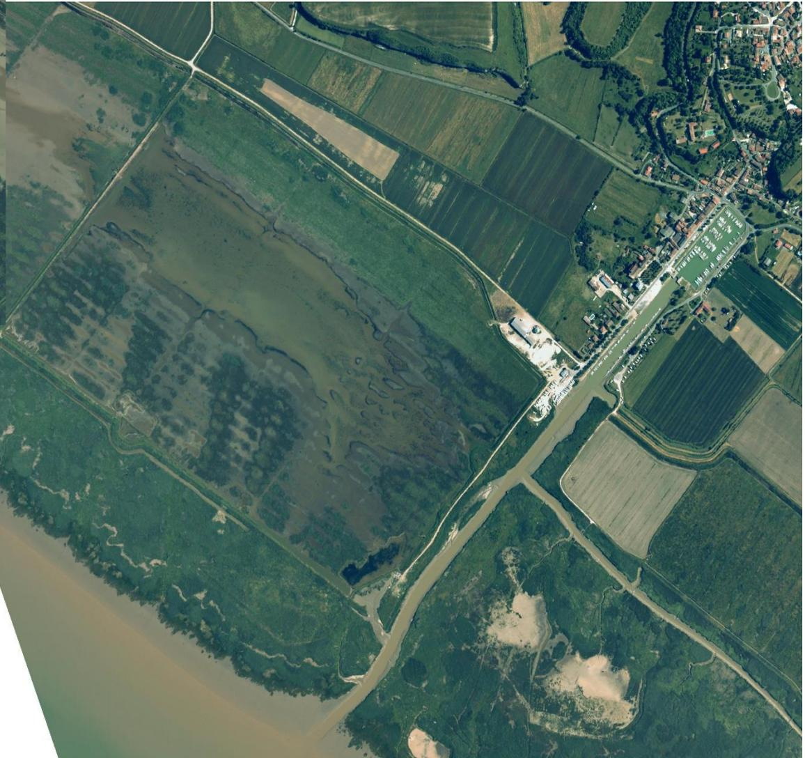
**Dans les années 2000** : abandon du polder agricole et reconnexion à l'estuaire. La digue n'est plus maintenue et les sédiments s'accumulent sur ces terrains bas. Progressivement, la végétation s'installe. Une digue de protection est érigée en arrière du polder pour protéger le village.
